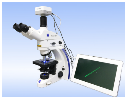
位相差・蛍光顕微鏡システム (アスベスト測定用特別仕様モデル)
